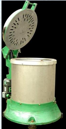
Cet équipement permet le séchage des pièces par la combinaison d'un mouvement rotatif et d'un chauffage électrique.
